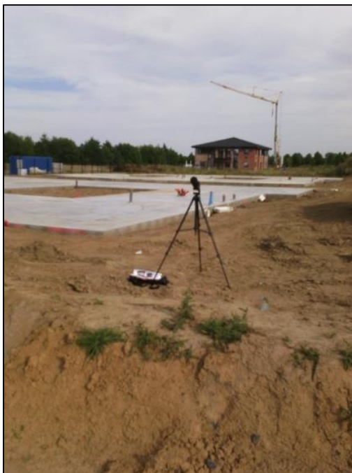
Exemple de mesure acoustique (matériel : sonomètre FUSION de classe 1 homologué)
